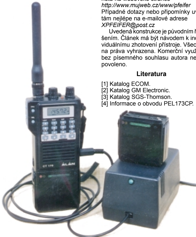
Obr. 9. Radiostanice s upraveným akupakem a zdrojem
