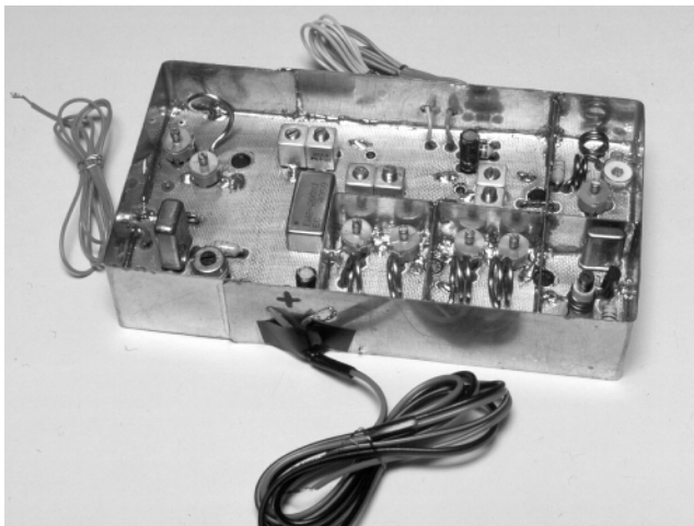
Obr. 6 a 7. Pohled na hotový transvertor z obou stran desky s plošnými spoji
