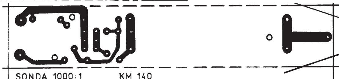
Obr. 19. Doska s plošnými spojmi 1000 : 1
