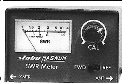
Obr. 1. Stupnice „provozních“ reflektometrů, kterými se průběžně kontroluje přizpůsobení na výstupu radiostanic, mají spíše informační charakter. Nezáleží ani tak na přesném ČSV (SWR) jako spíše na minimální výchylce. (Označení SWR je odvozeno z anglického Standing Wave Ratio - poměr stojatých vln)
