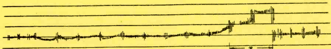
OSCILLOGRAMME TYPIQUE OBSERVÉ SUR LE VECTEUR-SCOPE POUR LA MESURE DE LA PHASE DIFFÉRENTIELLE
