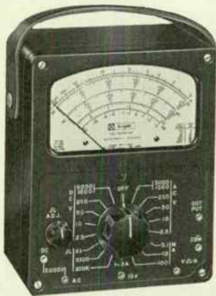
Fig. 1-1. Knight-Kit 20,000-ohms-per-volt VOM.
