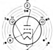
INDEX = LARGE LUG • = SHORT PIN - IC 12AQ
