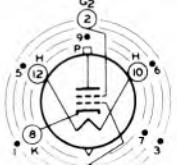
INDEX = LARGE LUG • = SHORT PIN - IC 12AS
