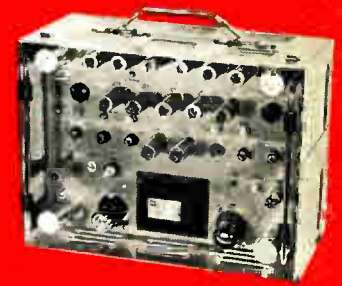
1073-CR SIN 2 —SQUARE WAVE GENERATOR
