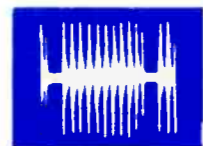
27 .3 VOLTS P/P, 15,750 HZ Q102 BASE R150, R151
