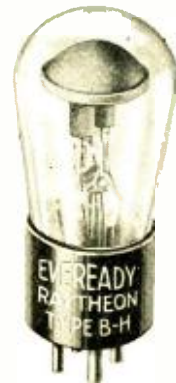
Type B-H 125 m. a. at 300 volts
