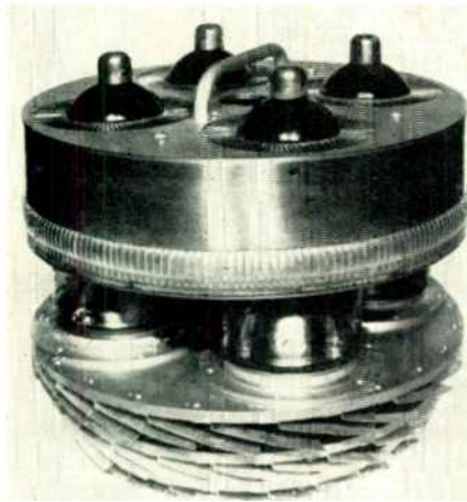
FIG. 6. THE EIMAC 3x12500A3 TRIODE
