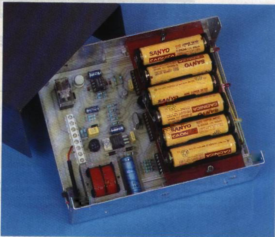
Photo 3. - Les six accumulateurs forment la batterie 7,2 V qui rend autonome le système lors d'une panne secteur.
