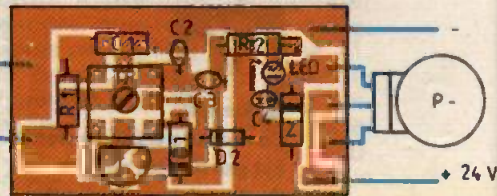
2/3 Dessin du circuit imprimé et implantation des composants.
