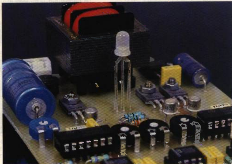
Photo 3. - La nouvelle LED dispose de cinq pattes d'alimentation.
