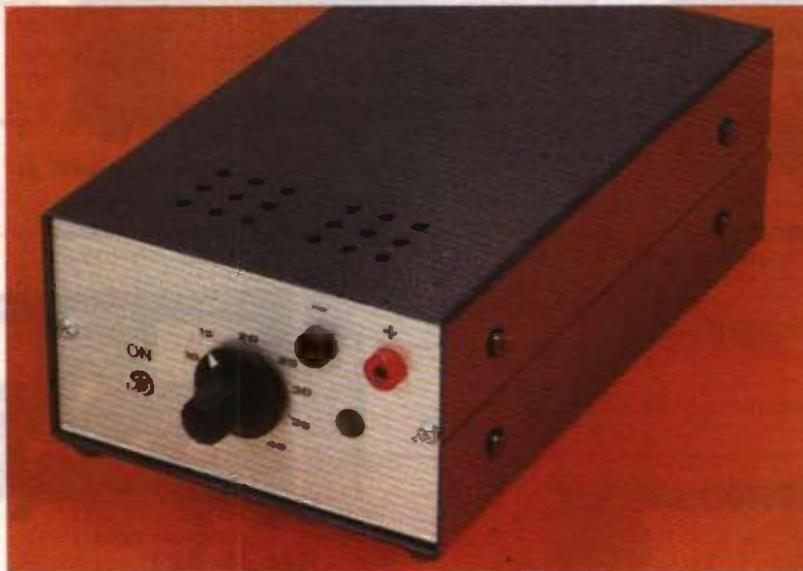
L'amateur électronique a souvent besoin de disposer de diverses valeurs de potentiel pour effectuer ses expérimentations. L'alimentation que nous vous proposons dans ces colonnes, outre sa simplicité, est capable de générer des valeurs de tension de 1,2 à 40 V sous une trentaine de watts.
