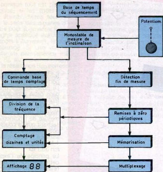
**2** Schéma synoptique de l'inclinomètre.
