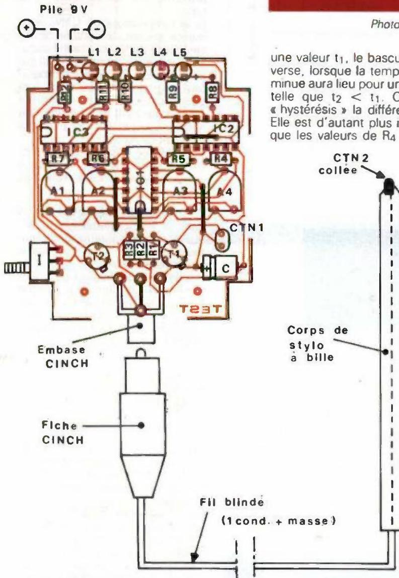
une valeur  $t_1$ , le basculement inverse, lorsque la température diminue aura lieu pour une valeur  $t_2$  telle que  $t_2 < t_1$ . On appelle « hystérésis » la différence  $t_2 - t_1$ . Elle est d'autant plus importante que les valeurs de  $R_4$  à  $R_7$  sont
