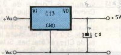
faible impédance. Les condensateurs  $C_2$  et  $C_3$  achèvent le découplage des tensions ainsi symétrisées. Le régulateur  $CI_3$  qui alimente les circuits logiques CMOS a pour rôle d'éviter le « parasitage » de l'alimentation principale ( $V_{cc}$ ) par ces mêmes circuits logiques. Sans ce régulateur, on retrouve sur la ligne  $+V_{cc}$  une ondulation de fréquence  $F_0$  néfaste à la stabilité des seuils des compara-
