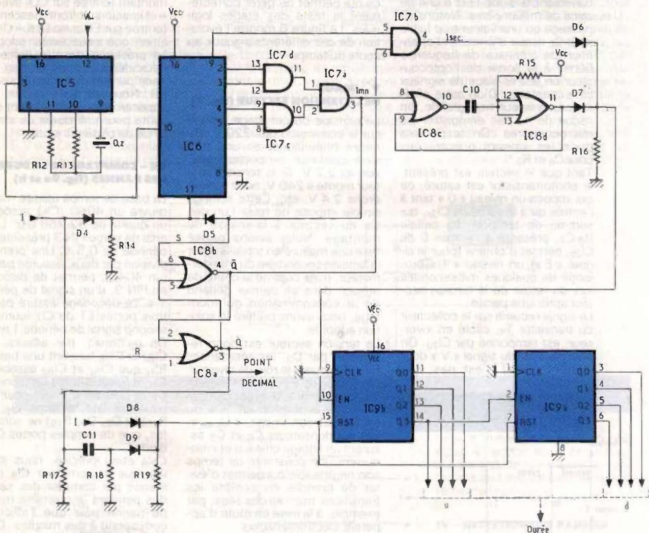
riode 1 s peut-il franchir la porté ET (IC7b) et faire évoluer l'état du compteur IC6 (qui compte alors en secondes). Au bout de 1 min, une impulsion apparaît à la sortie de IC7a qui re-
