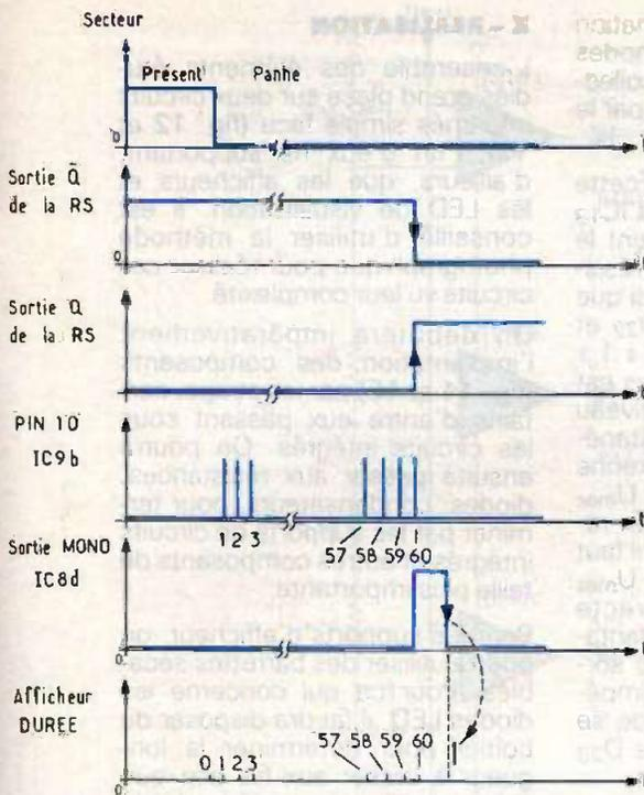
par les afficheurs sept segments Cl<sub>14</sub> et Cl<sub>15</sub>. Pour éviter une consommation excessive sur la pile pendant les périodes de panne, on inhibe l'affichage en portant l'entrée BL à zéro grâce au signal de validation « V ».
