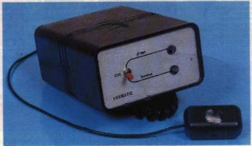
Qu'importe, puisque dès que tombe la nuit, et en s'adaptant automatiquement et parfaitement aux diverses saisons, notre détecteur commande une charge quelconque, et s'empresse naturellement de la mettre hors service dès que l'aube s'annonce. Un réglage précis de la luminosité ambiante est prévu et très facile à mettre en œuvre.
