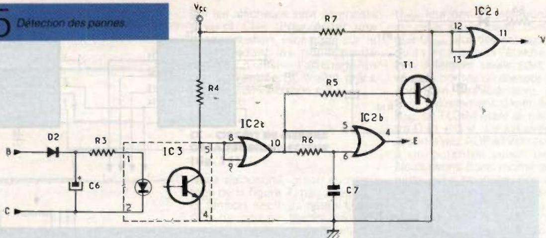
confié à C<sub>6</sub>. R<sub>3</sub> limite le courant traversant la diode LED à une dizaine de milliampères. Notons au passage qu'une valeur trop faible pour C<sub>6</sub> risque d'entraîner l'apparition de crêneaux de fréquence 50 Hz à la sortie de l'optocoupleur en lieu et place de signaux bien constants. D'un autre côté, avec une valeur trop grande, on risque de ne pas enregistrer les microcoupures. On respectera donc les valeurs préconisées pour C<sub>6</sub> et R<sub>3</sub>.
