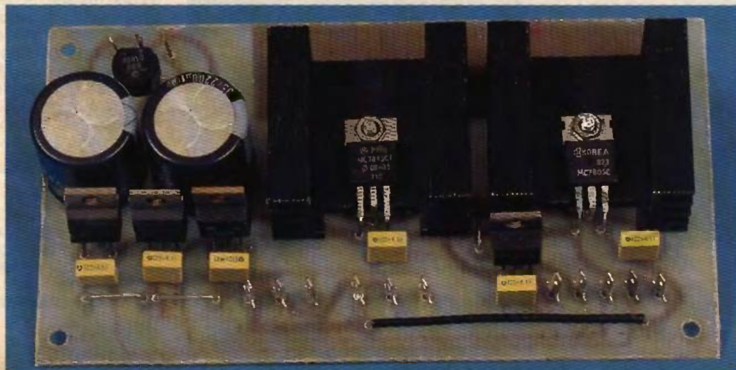
Photo 6. - Les circuits régulateurs R 1 -R 3 munis de leurs radiateurs.
