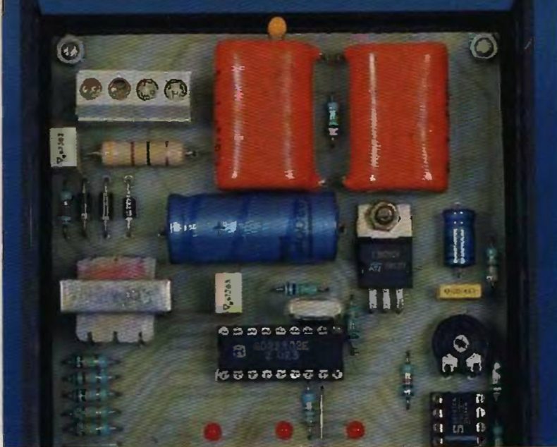
Photo 3. - On aperçoit les condensateurs de l'alimentation.
