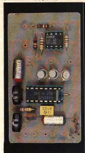
Photo 3. - Notez la présence du strap sous le circuit intégré.
