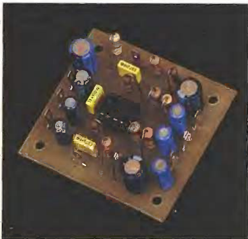
Photo 3. - Le module préamplificateur.
