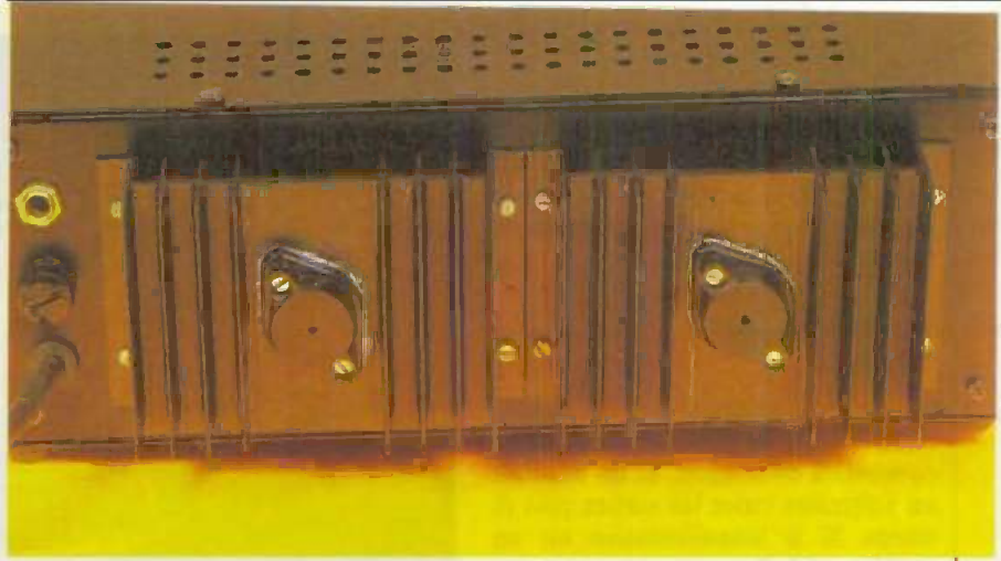
Photo 6. - Protection des transistors de sortie.
