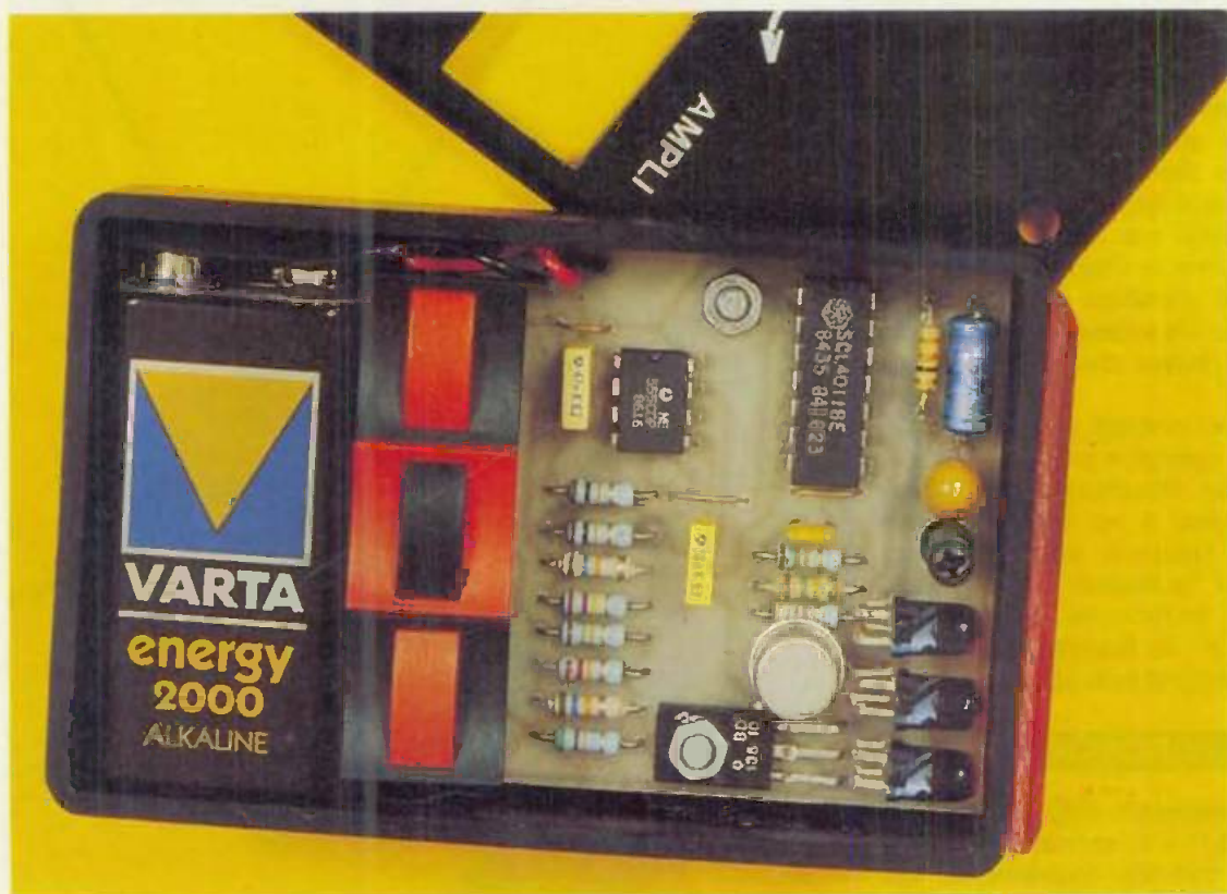
Photo 2.- Vue intérieure du boîtier émetteur.
