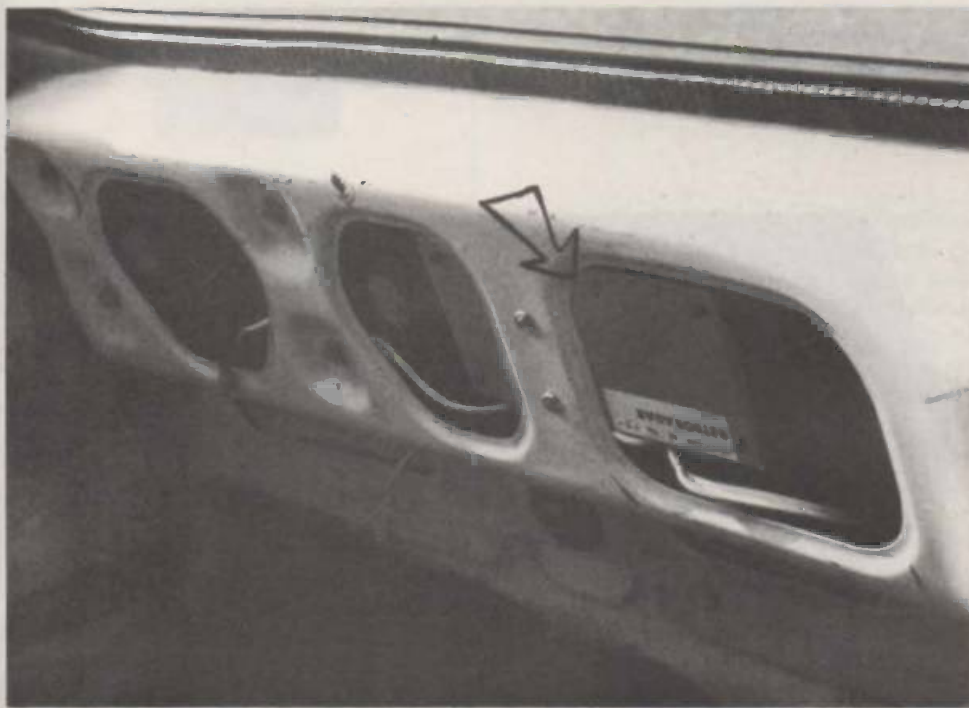
Photo 9. — Le coffret Teko 4/B a pu être vissé derrière des renforts dans le coffre...
