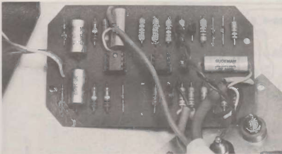
Photo 2. — Certaines liaisons s'effectueront à l'aide d'un fil blindé.
