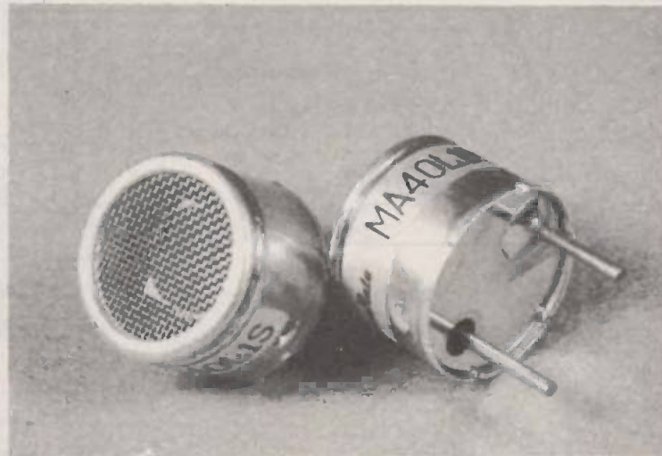
Photo 3. — Les transducteurs MURATA, suffixes S pour source et R pour récepteur (Ø 16 mm).
