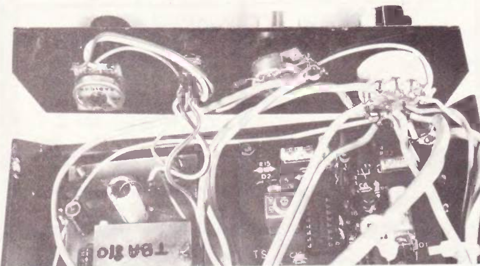
Photo 3. — Les deux modules sont fixés côte à côte au fond du boîtier.
