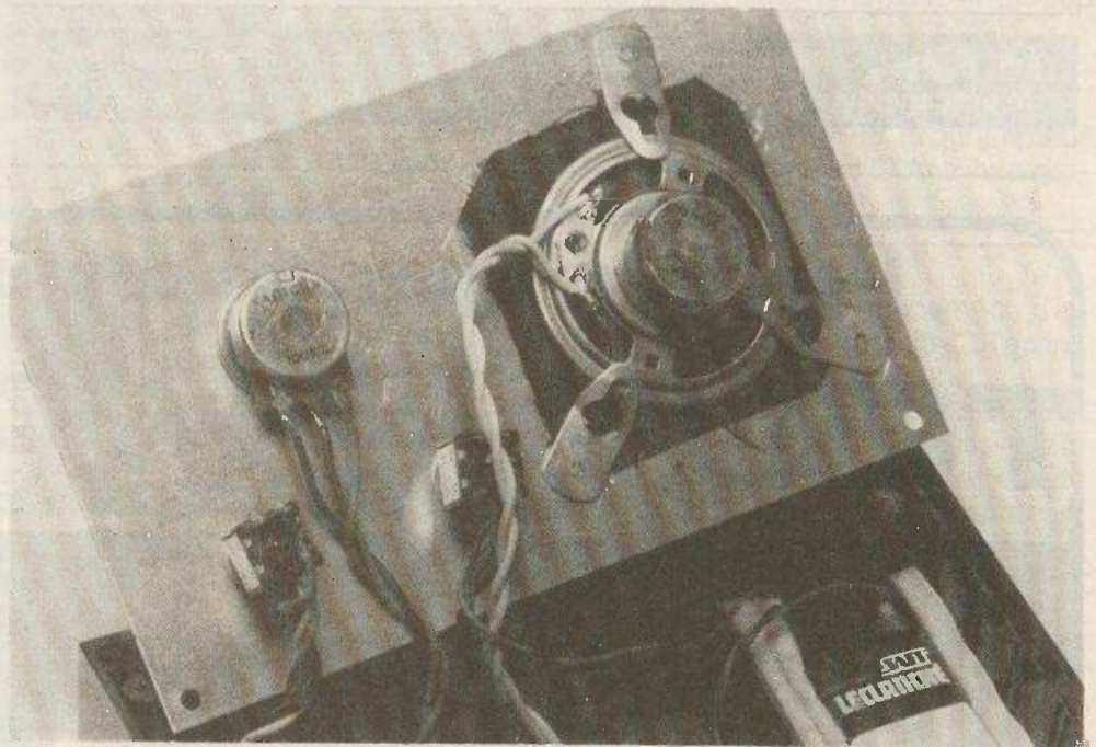
Photo 3. – Un moyen pratique de maintenir le haut-parleur contre la face avant.
