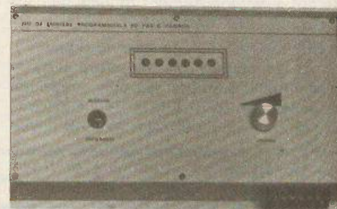
Photo 7. – Sur la face avant apparaissent 6 diodes LED qui permettent de vérifier à tous moments la programmation.
