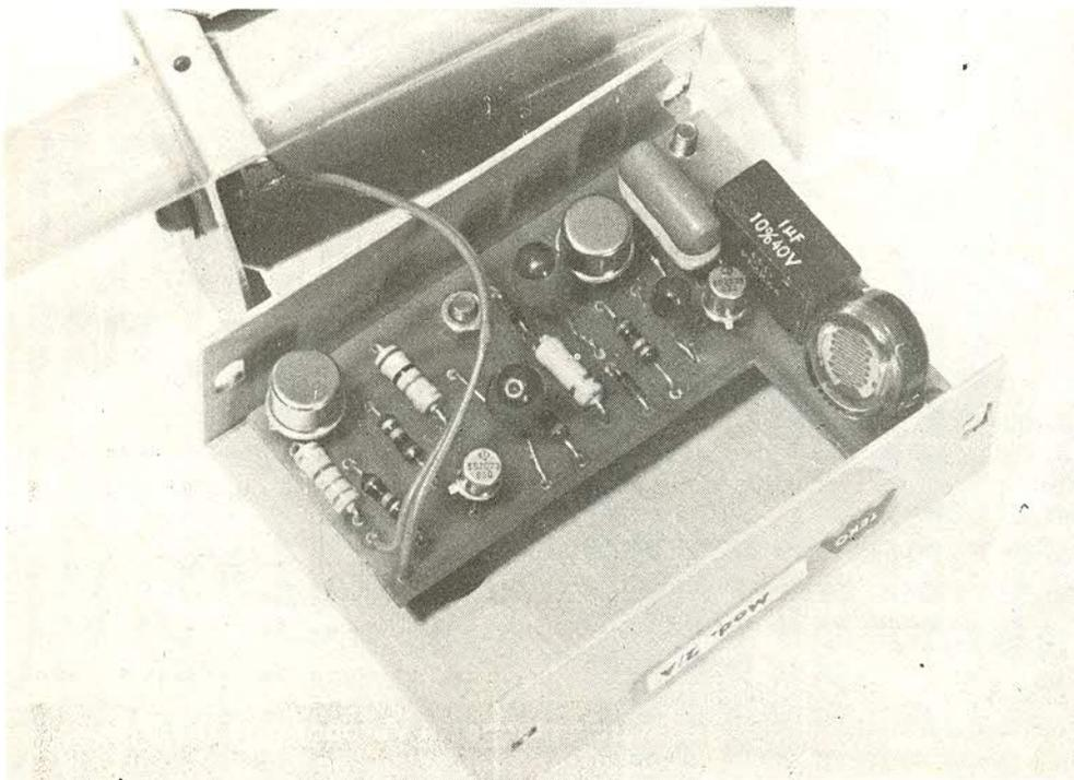
Photo G. – On a prévu la découpe du circuit imprimé pour le passage du tube.
