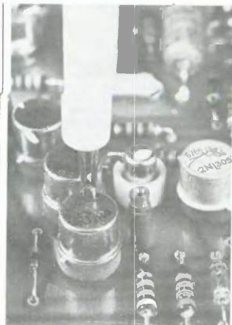
Photo 9. – Cette sonde permet de surveiller la température d'un transistor, même si son boîtier est sous tension.
