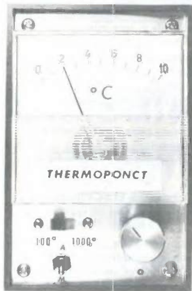
Photo 6. – Les commandes sont groupées sous le galvanomètre : l'inter, le commutateur de gammes et le bouton d'affichage de la température ambiante.
