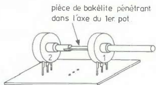
Fig. 4. à 6. - Pour faciliter les raccordements vers le commutateur on réalisera une petite plaquette spéciale supportant les éléments destinés à être insérés dans les circuits de contre-réaction. Tracé du circuit imprimé du module amplificateur et implantation des éléments. Comment jumeler des potentiomètres « simples ».
