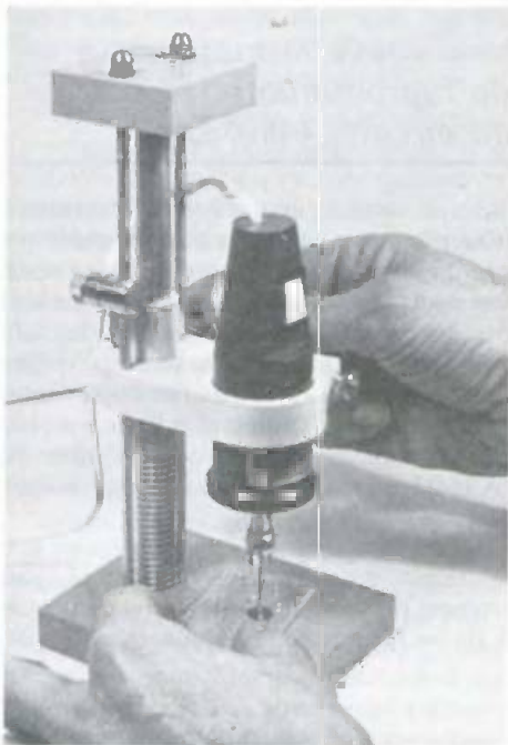
Photo 6. – Le perçage de la plaque à \varnothing 1 mm ne pose aucun problème.
