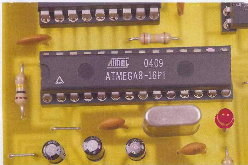
Le cœur du montage, un microcontrôleur ATMEL
