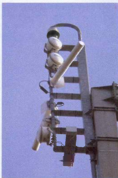
Les antennes hélicoïdales servent souvent à déporter des caméras de surveillance
