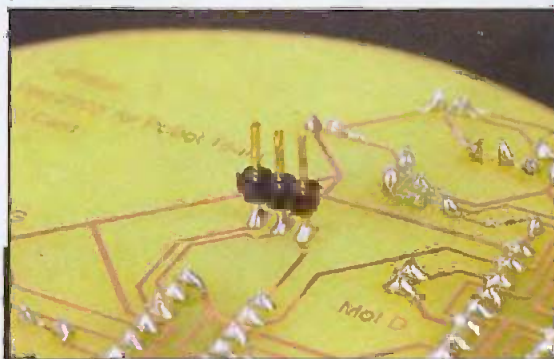
Principe de la liaison entre les deux platines
