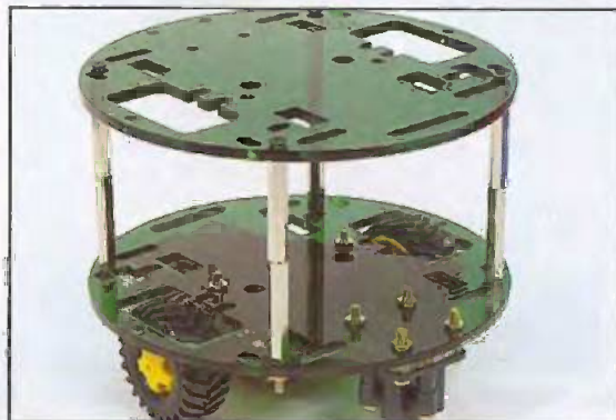
La version POLOLU 2 équipée d'un étage supplémentaire.
