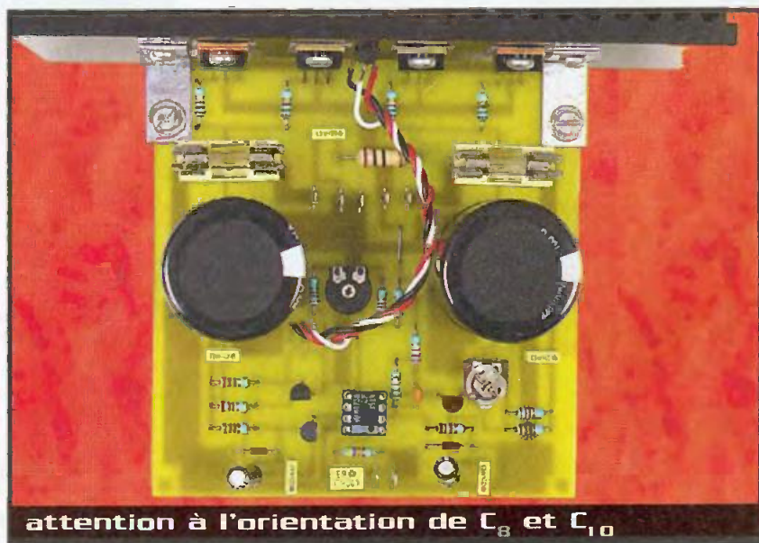
4 Montage correct des accessoires d'isolement
