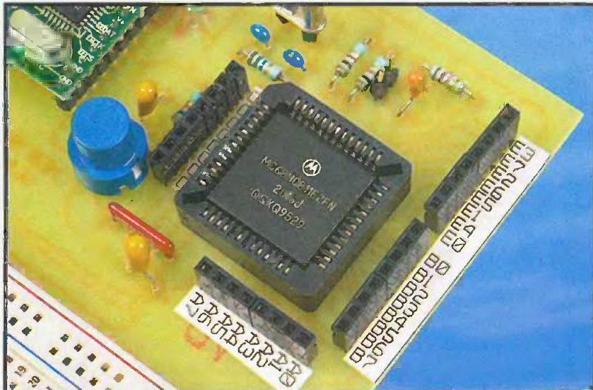
Le microcontrôleur sur support PLCC 52
