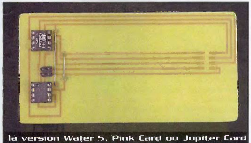
12 Schéma Interne d'une carte à puce Wafer 5 ou Jupiter Card
