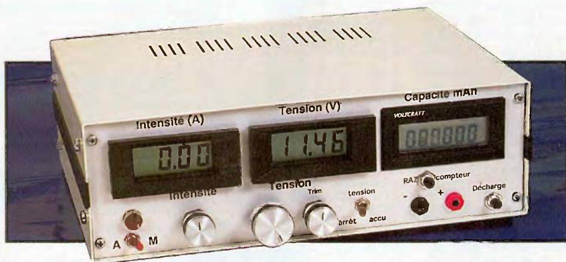
Il est intéressant et utile de mesurer la capacité pour contrôler l'état général de la batterie (les batteries au Cadmium Nickel souffrent de l'effet mémoire, si elles ne sont pas correctement chargées et déchargées leurs capacités peuvent diminuer) ou pour contrôler ce qu'il "reste" dans la batterie, après un usage partiel, pour en déduire la durée maximale d'utilisation.
