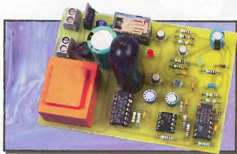
redressement réalisé par un pont de diodes, la capacité C<sub>1</sub> effectue un premier filtrage. Sur la sortie d'un régulateur 7809, on relève un potentiel continu stabilisé à 9 V. La capacité C<sub>2</sub> réalise un filtrage complémentaire tandis que C<sub>3</sub> découple l'alimentation du montage, proprement dit.
