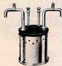
STANDARD RESISTOR REICHANSTALT TYPE
