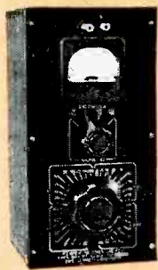
POWER OUTPUT METER
