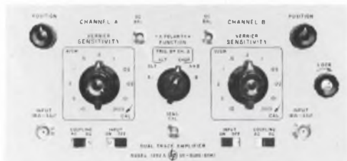
1402A—20 MHz Dual Trace Amplifier
