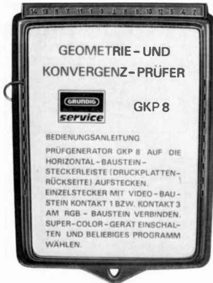
Bild 1 Ansicht des Geometrie- und Konvergenz-Prüfers GKP 8
