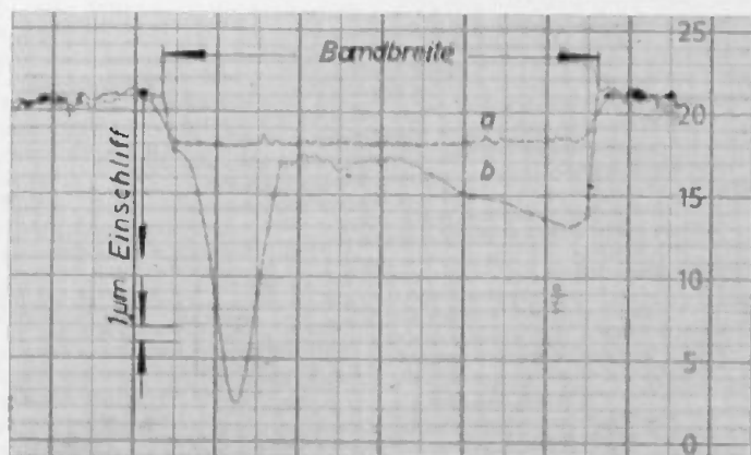
Bild 3 Einschliff-Profil einer Tonkopf-Frontfläche a) bei natürlichem Verschleiß, b) bei unsystematischen Verschleiß-Ursachen, die zu Mulden geführt haben
