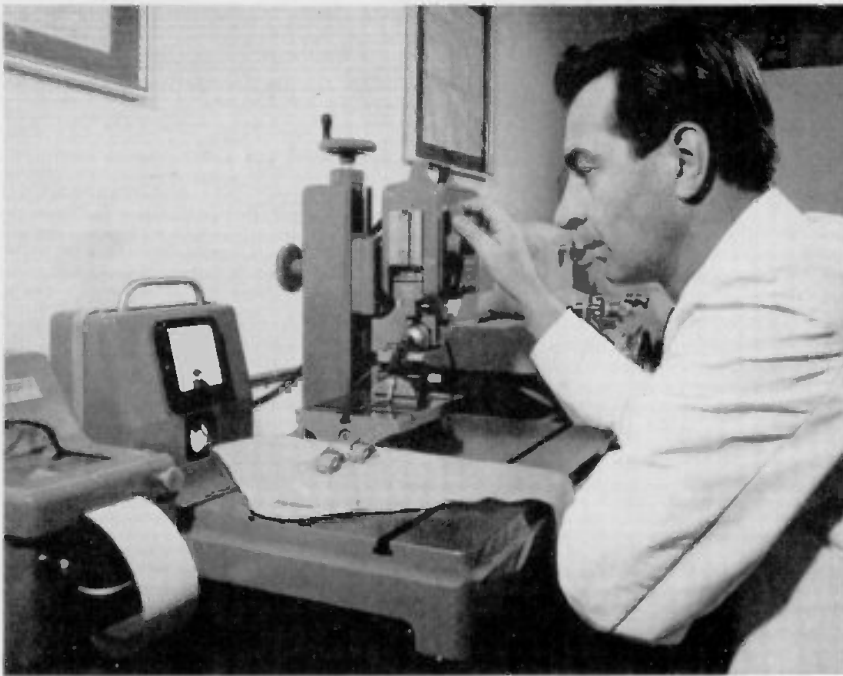
Bild 4 Feinmeßtechnischer Prüfplatz in der GRUNDIG Tonkopf-Fertigung
