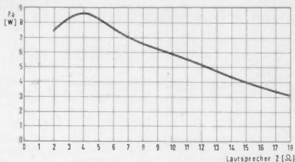
Bild 6 Leistungsabgabe in Abhängigkeit vom Lautsprecher-Abschlußwiderstand
