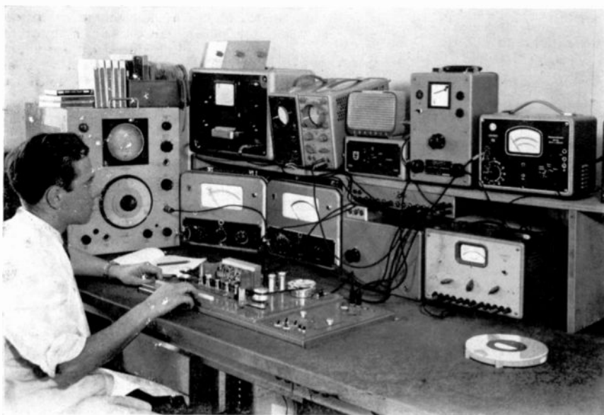
Ein elektroakustischer Bandmeßplatz im GRUNDIG Tonbandlabor
