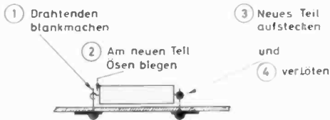
Bild 3 und 4 Auswechseln defekter Widerstände und Kondensatoren.
