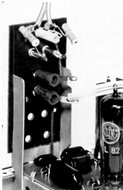
Bild 9 Antennenplatte mit UHF-Antennenbuchsen
