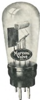
Marconi GUI Mercury Vapour Rectifier.
