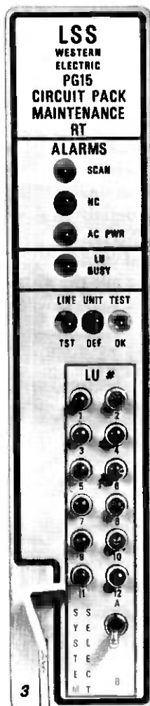
Fig. 6—LSS RT maintenance unit.
