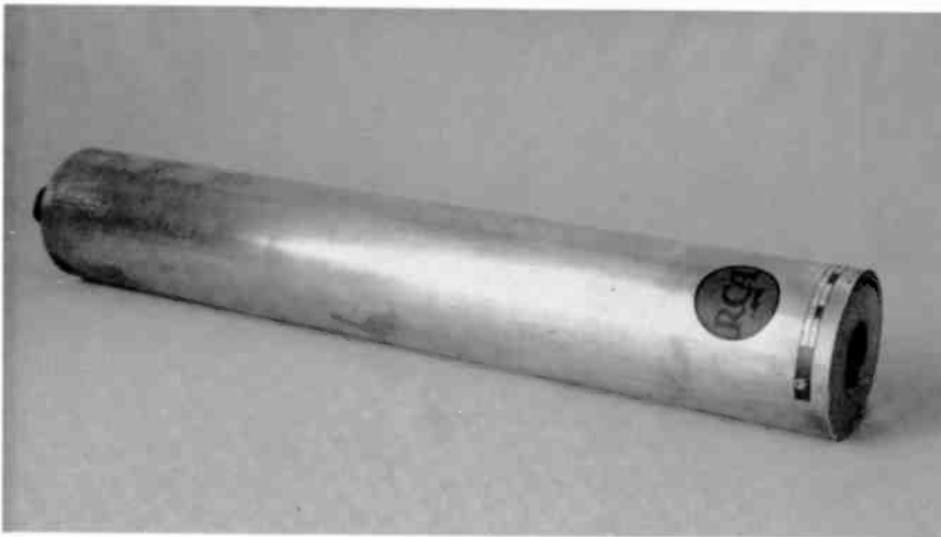
Fig. 4—Radial heat pipe.
