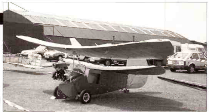
The original micro light: Mignet Pou-Du-Ciel.
