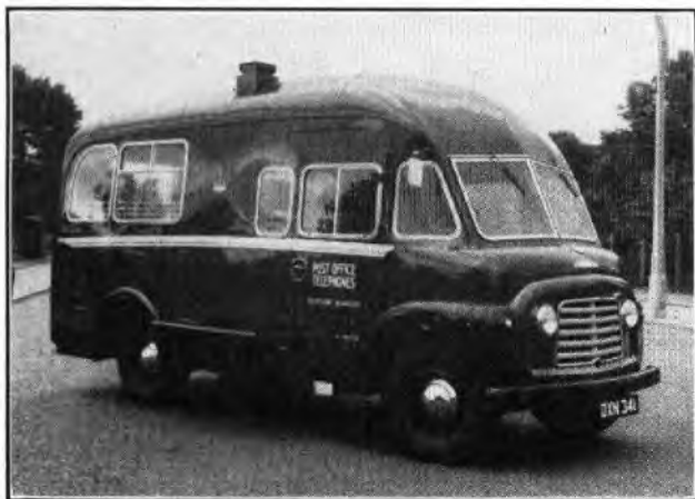
FIG. 6.—MODERN CABLE-TEST VAN.
