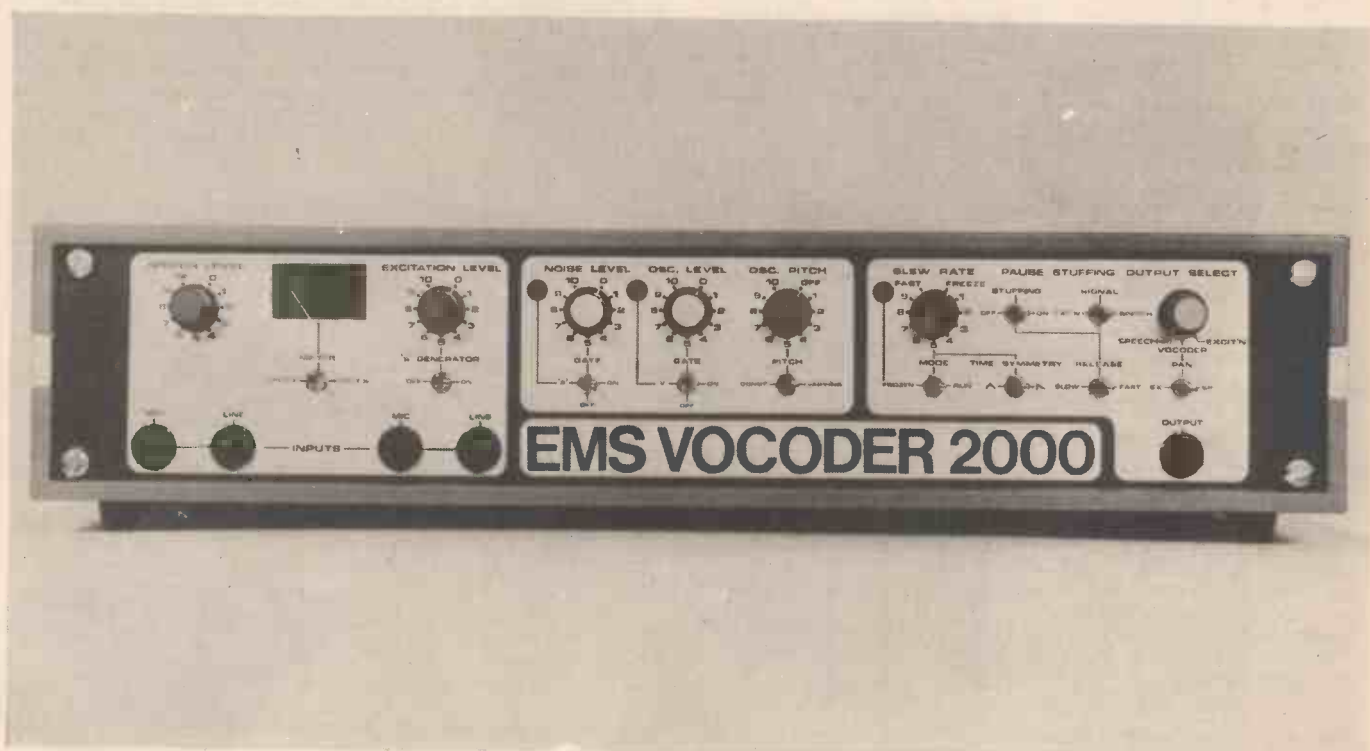
Fig. 20. The EMS Vocoder 2000
