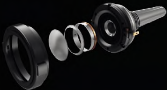
Decoupled Double Dome tweeter
