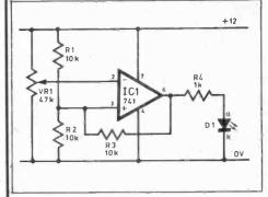
Fig. 5.6a. An op-amp Schmitt trigger.
