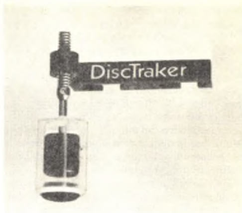
Il Disc Traker, prodotto dalla Discwasher, è attaccato al supporto della cartuccia, in modo che un morbido cuscinetto di velluto risulta a contatto con la superficie del disco. Il suo scopo è quello di eliminare gli effetti prodotti da ondulazioni verticali del disco
