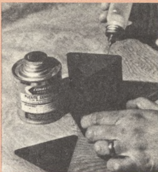
Fig. 7 - Il collante solvente acrilico si applica facilmente e si asciuga in pochi minuti. In questa foto è rappresentato uno dei pezzi laterali mentre viene incollato alla scatola dell'orologio.
