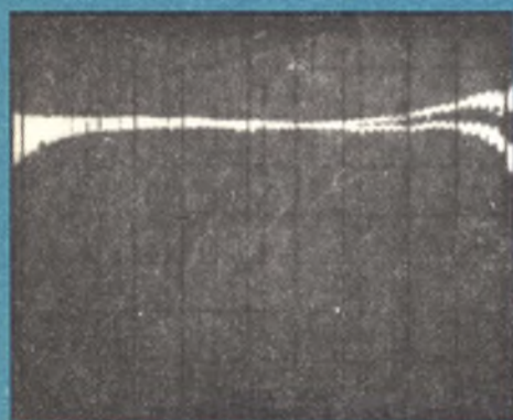
Fig. 7 - La traccia superiore, che mostra un livello crescente alle alte frequenze, rappresenta la risposta ottenuta in sede di riproduzione a partire da segnali con frequenze diverse, registrati su un nastro che richiede la polarizzazione adatta per i nastri di tipo CrO 2 , usando la polarizzazione "normale". La traccia inferiore è stata ottenuta usando la polarizzazione corretta.
