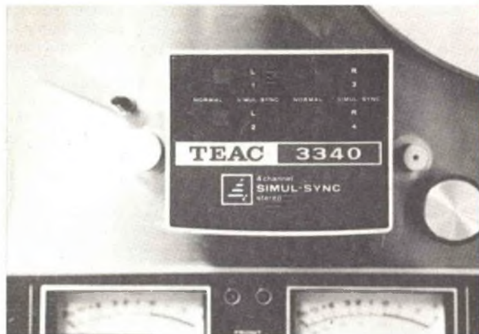
Veduta ravvicinata dei commutatori di pista "Simul-Sync" sul registratore Teac modello 3340.
