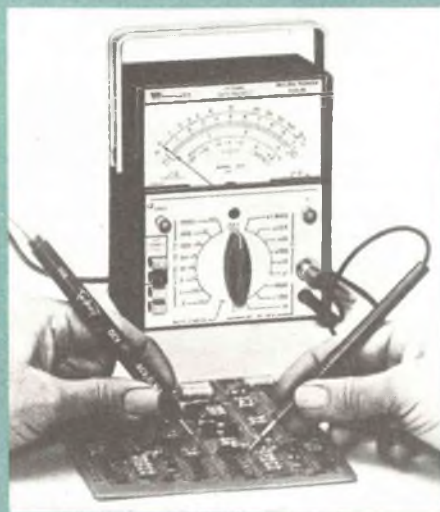
Il tester modello 603 prodotto dalla Tripplett è uno strumento che utilizza componenti allo stato solido, dotato di una sonda con resistore di protezione incorporato, che può essere inserito per la misura di grandezze in continua e di resistenze con l'impiego di bassi livelli di potenza.
