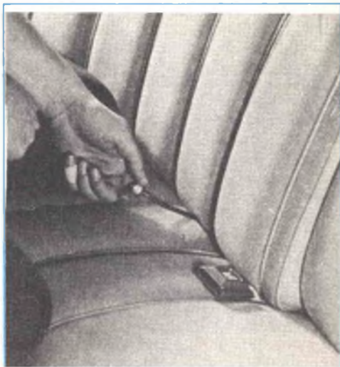
Fig. 8 - Si fa passare il cavo dal bagagliaio all'interno della vettura.
