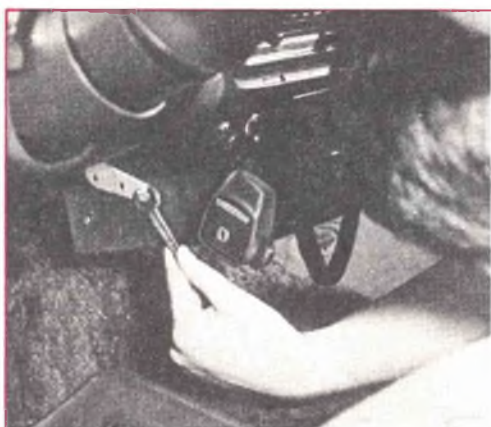
Fig. 2 - Montaggio del ricetrasmittitore sotto il cruscotto.
