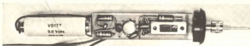
Questa fotografia mostra i particolari di montaggio dei componenti e la posizione della staffetta con connettore per la batteria, a sinistra del circuito stampato.
