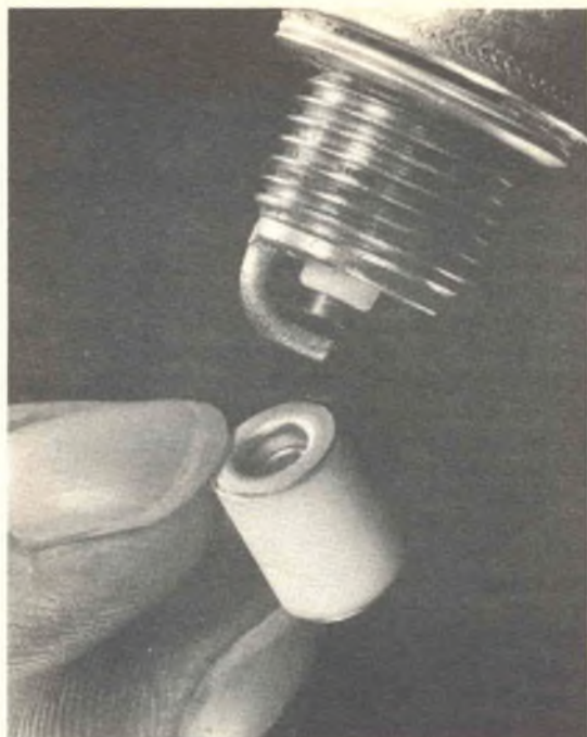
Fig. 2 - Il nuovo spinterometro Siemens FS 10, lungo appena 11 mm, può essere montato direttamente nel cappuccio della candela e viene collegato in serie agli elettrodi della stessa. In questo modo il processo di accensione rimane costante anche quando sugli elettrodi sono presenti depositi di fuliggine e di piombo.
